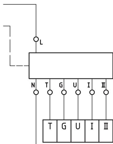
T = Piezoschalteranschluss LED Ring Funktion Kabel schwarz
